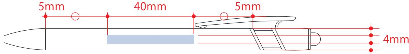
■ レーザー印刷 最大範囲：W40×H4(mm)
